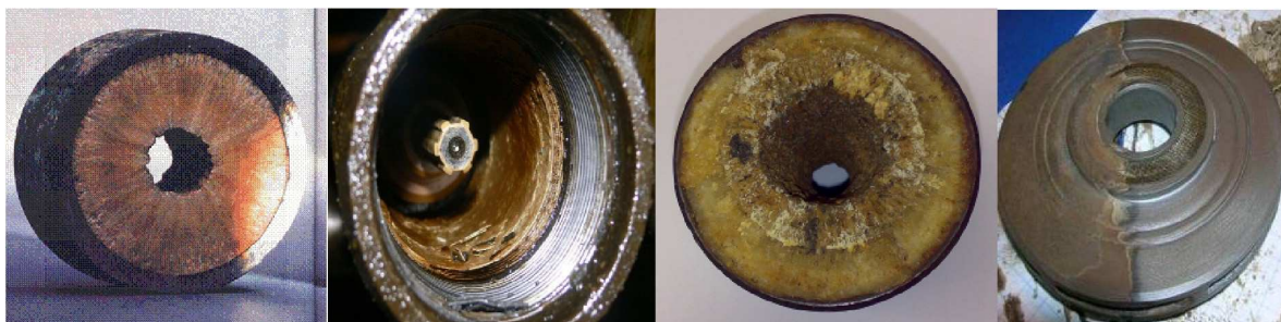
Рисунок 12 – Пример результата солеотложений в НКТ и на рабочих органах насосов
