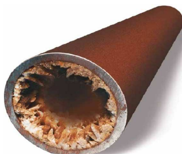
Рисунок 6 – Отложение солей на внутренних стенках НКТ
