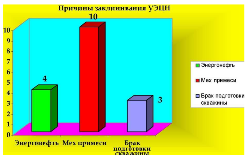
Рисунок 13 – Причины заклинивания УЭЦН
