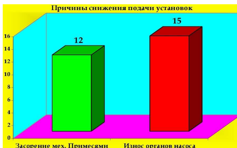
Рисунок 12 – Причины снижения подачи УЭЦН
