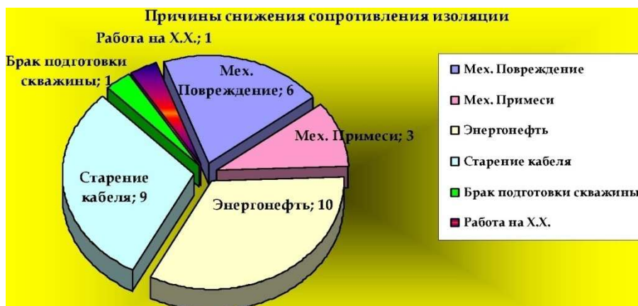
Рисунок 11 – Причины снижения сопротивления изоляции УЭЦН
