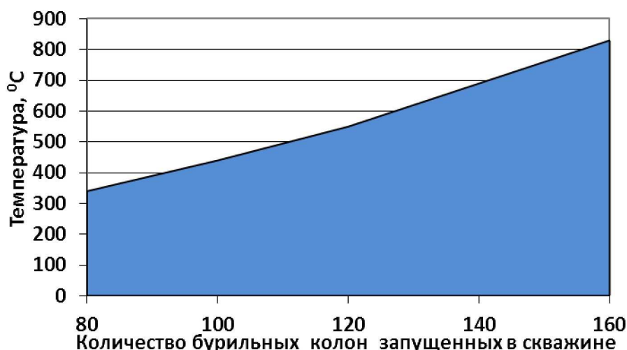
Рисунок 1 – Изменение температуры на поверхности трения в зависимости от количества бурильных колон [4]
