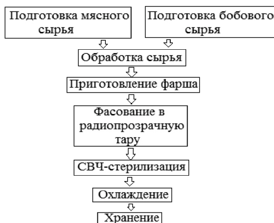
Рисунок 5 – Технологическая схема производства паштетов
