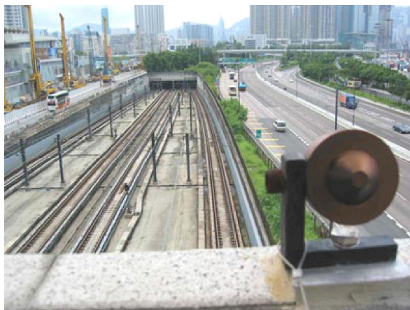
Рисунок 3 – Автоматизированный геодезический мониторинг при помощи прецизионной линзы
