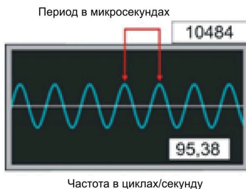
Рисунок 3 – Частота колебаний измерительных трубок
