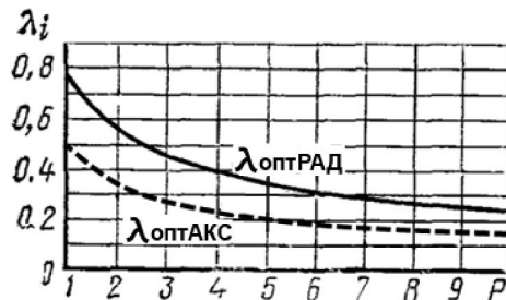
Рисунок 10 – Оптимальное отношение расчётной длины активной зоны магнитопровода к диаметру эталонной окружности для радиальных и аксиальных ЭМ
