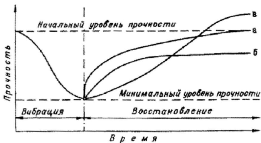
Рисунок 4 — Кинетика восстановления прочности тиксотропной системы (а) и квазитиксотропных природных грунтов (б, в)
