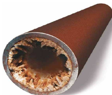
Рисунок 6 – Отложение солей на внутренних стенках НКТ
