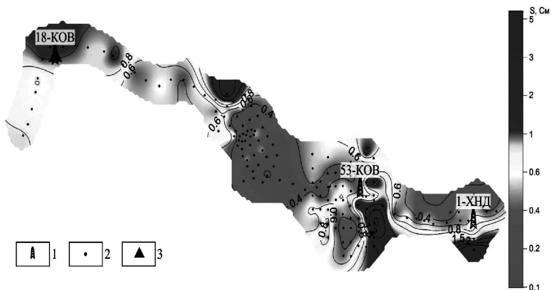
Рисунок 5 – Карта проводимости христофоровского горизонта: 1 – скважина; 2 – пункты ЗСБ; 3 – приток рапы с АВПД
