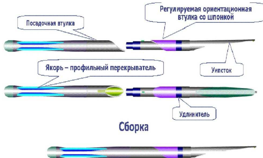
Рисунок 7 – Установка ориентированного уипстока в эксплуатационной колонне для бурения бокового ствола (нескольких стволов)
