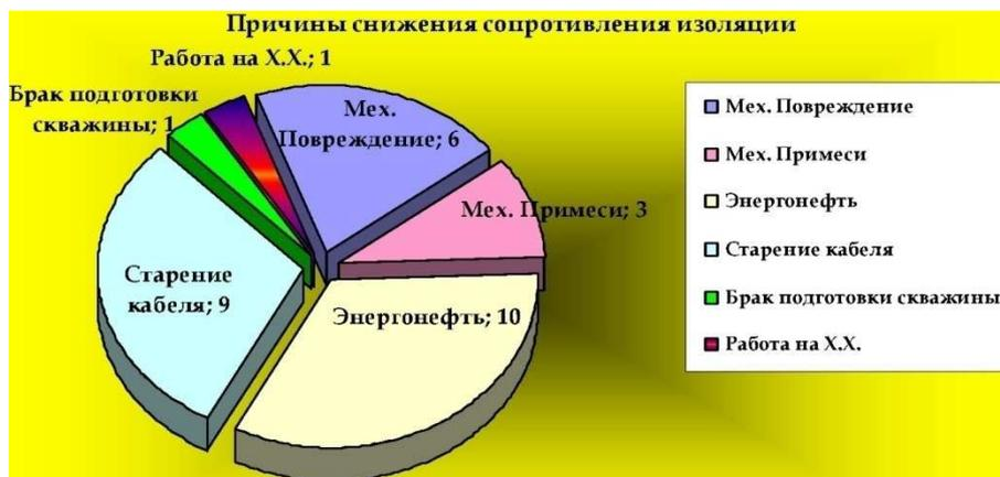
Рисунок 11 – Причины снижения сопротивления изоляции УЭЦН
