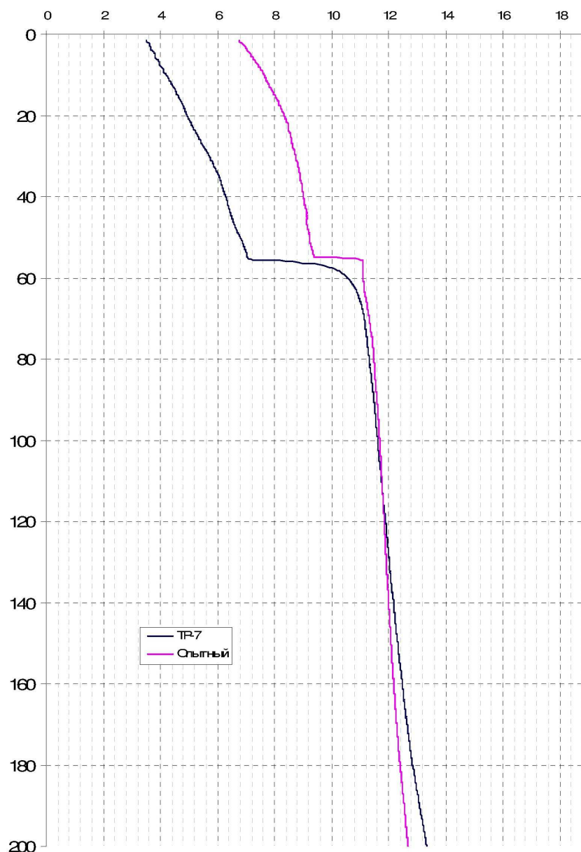
Рисунок 2 – Реакция термометров TP7-341 и ВМСТ-1 на скачок температуры в момент перехода из воздуха в воду
