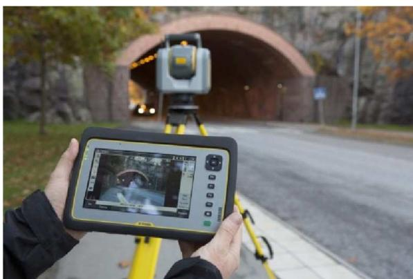
Рисунок 3 – Сканирующий тахеометр Trimble SX10
