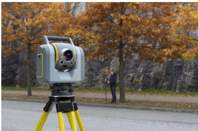
Рисунок 2 – Сканирующий тахеометр Trimble SX10
