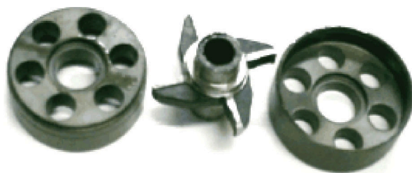
Рисунок 6 – Общий вид измельчителя мехпримесей ЭЦН
