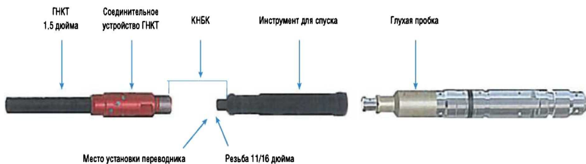
Рисунок 16 – Компоновка установочного инструмента при использовании колтюбинга
