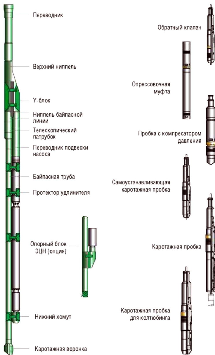
Рисунок 1 – Комплектация байпасной системы Y-Tool
