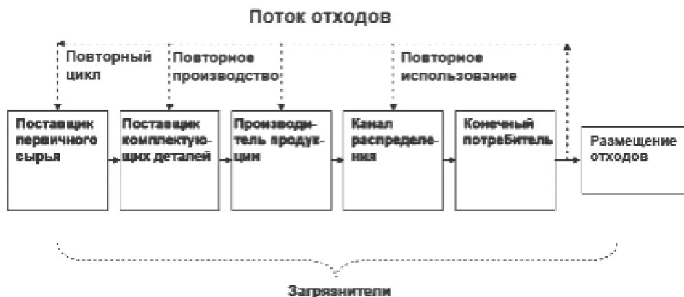
Рисунок 4 – Упрощённая блок-схема обратной цепи поставок, обеспечивающей перемещение и преобразование потока отходов(отходопотока) за счёт операций повторного использования, повторного производства и повторного цикла переработки отходов
