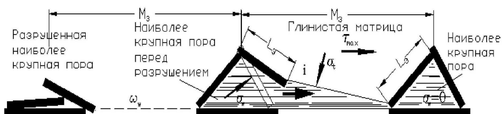
Рисунок 1 — Схема прорыва глинистой матрицы водой из наиболее крупной поры
