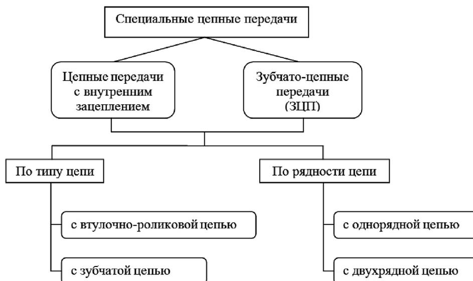
Рисунок 1 – Классификация специальных цепных передач
