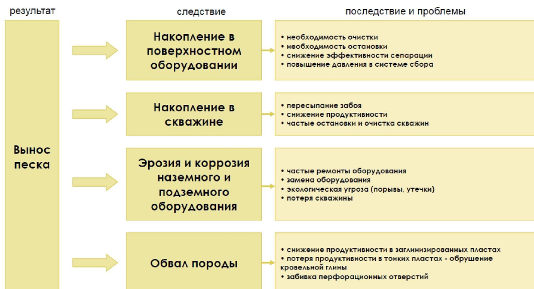
Рисунок 3 – Последствия выноса песка [6]
