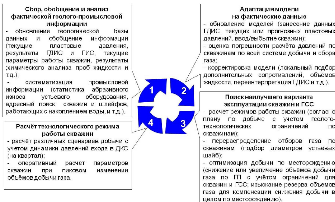
Рисунок 9 – Цикл обоснования режимов работы системы добычи и сбора газа [7]
