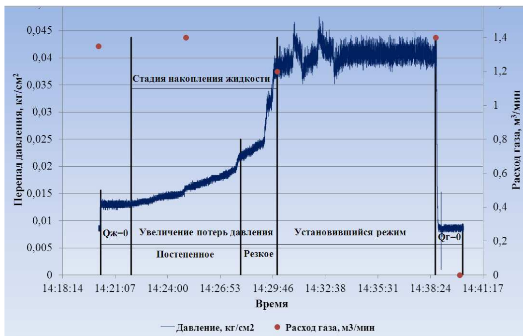
Рисунок 2 – Результаты исследования на стенде «призабойная зона – скважина»
