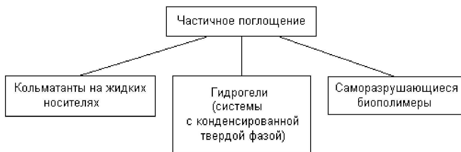
Рисунок 1 – Схема применяемых методов и составов, используемых для временного блокирования на скважинах ПХГ при частичном поглощении
