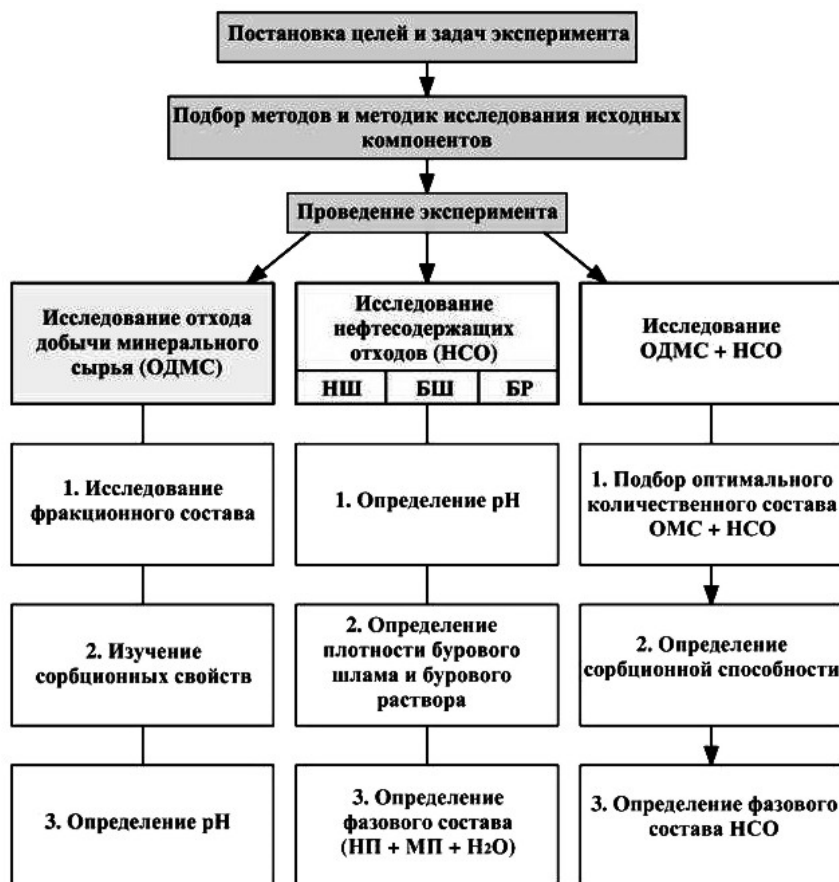
Рис. 1. План проведения эксперимента по исследованию отхода добычи минерального сырья в качестве сорбента
